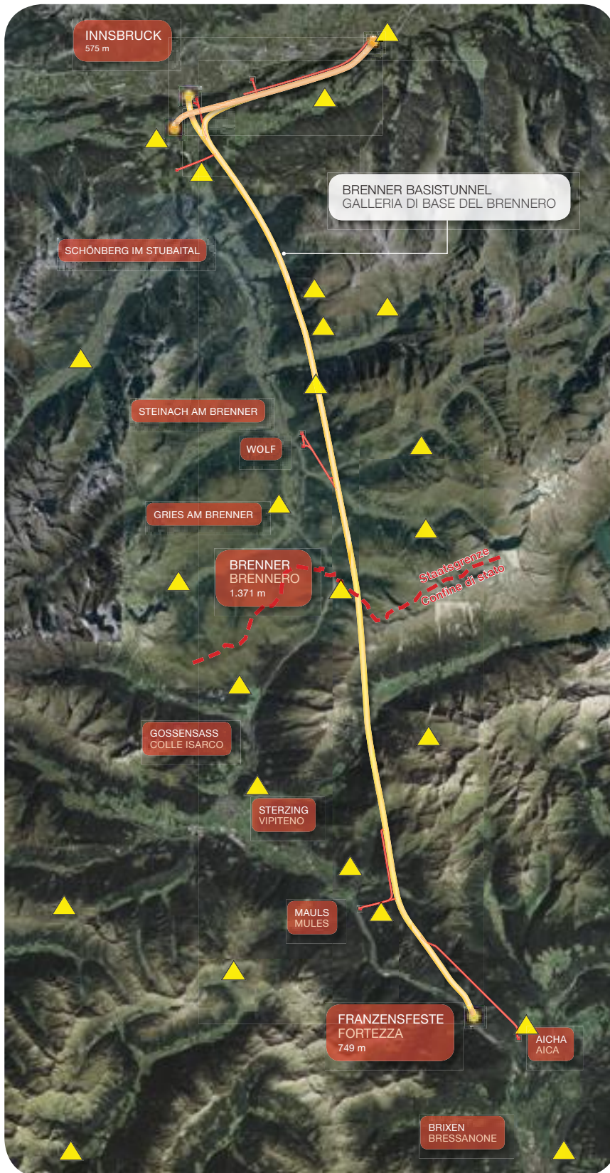
La rete geodetica d'inquadratura è una rete di punti di misura (evidenziati in giallo), distribuiti in un'area vasta che formano la base per il rilievo della Galleria di Base del Brennero in combinato disposto con il sistema GPS.
