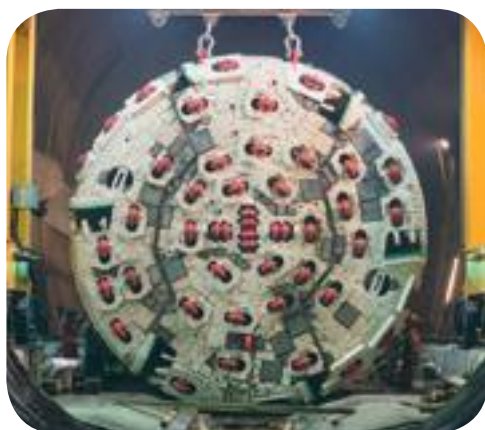
La testa della fresa presenta numerosi cutter. Questi frantumano la roccia in piccoli pezzi che successivamente vengono rimossi.
