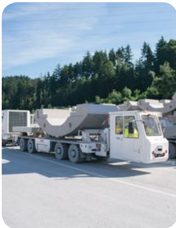
L'approvvigionamento della fresa nel cunicolo esplorativo di Ahrental-Pfons viene svolto dal così detto „Multi Service Vehicle“.
