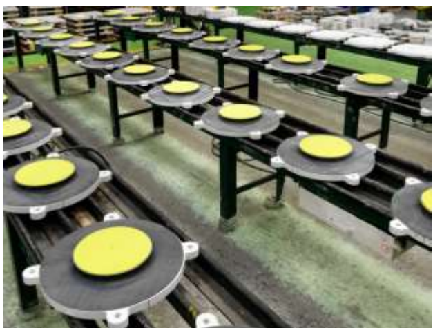
Figura 10 – Alcuni degli isolatori "a pendolo scorrevole" ( Sliding Isolation Pendulum o SIP) realizzati dalla società FIP Industriale nell'ambito del Progetto C.A.S.E. (si notino le necessarie protezioni dalla polvere e da altri agenti esterni)
